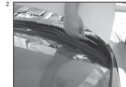
H011 push type cowl grille retainer arrêtir-poussoir de la grille du tablier retén de presión de rejilla del cubretablero
